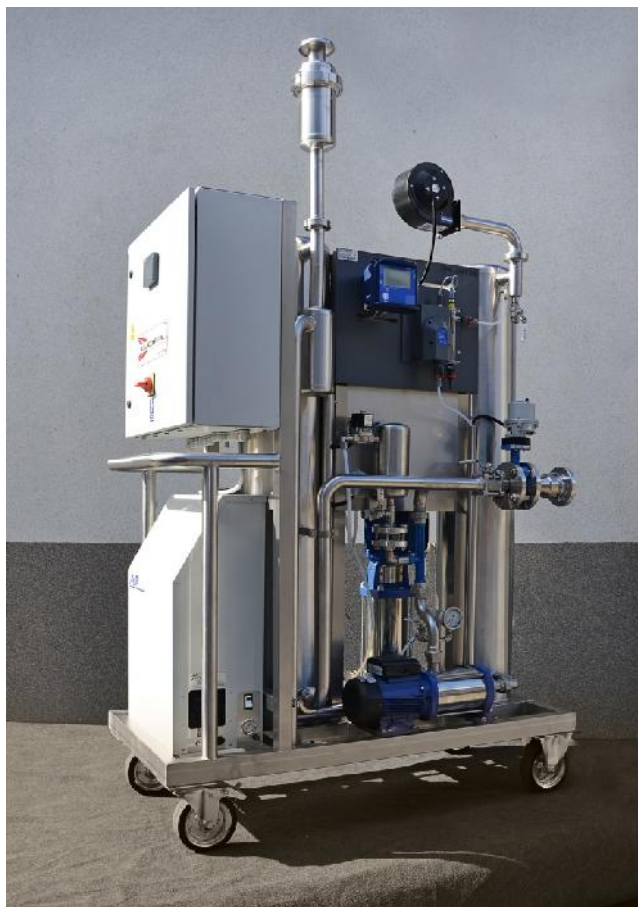
Rys. 2. Mobilny system dezynfekcji ozonem SPID - WOFIL Fig. 2. Mobile ozone disinfection system SPID - WOFIL
